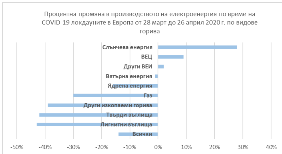
Фиг. 3. Процентна промяна в производството на електроенергия по време на COVID-19 локдауните в Европа от 28 март до 26 април 2020 г. по видове горива
